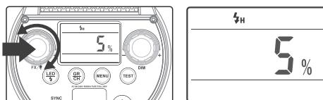
**Спецэффекты ВКЛ/ВЫКЛ:** В режиме LED нажмите кнопку моделирующей лампы/спецэффектов (мультиселектор «1»), чтобы включить или выключить спецэффекты.
